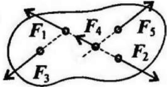
39. Если определённая равнодействующая сила при графическом сложении векторов в плоской системе сходящихся сил, оказалась равна нулю, то это будет означать:
